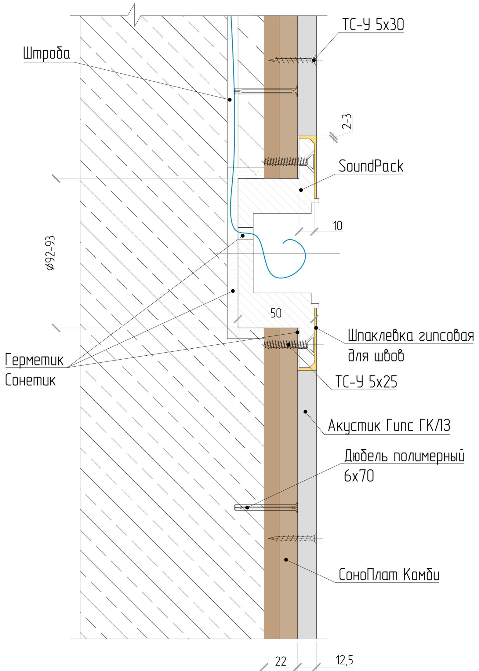
\* Диаметр сверления Ø93 мм
